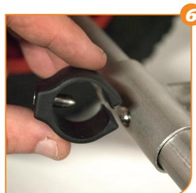
6 Introduire la roue dans l'axe de la base, valve vers l'extérieur.
