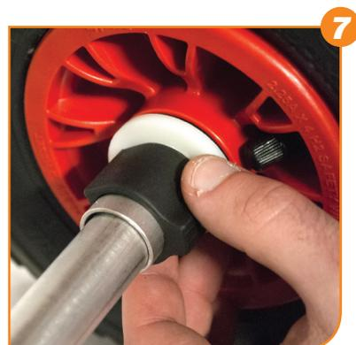
7 Introduire la roue dans l'axe de la base, valve vers l'extérieur.
