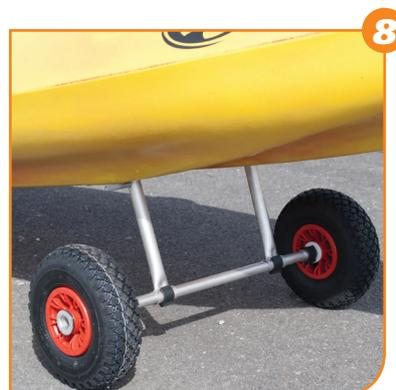
8 Introduire la roue dans l'axe de la base, valve vers l'extérieur.
