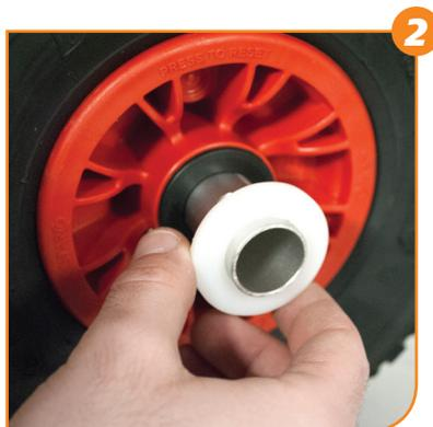
2 Introduire la roue dans l'axe de la base, valve vers l'extérieur.
